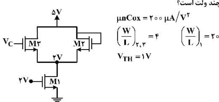
۱+۸ - مقدار ولتاژ گیت ترانزیستور M3 چند ولت است؟
