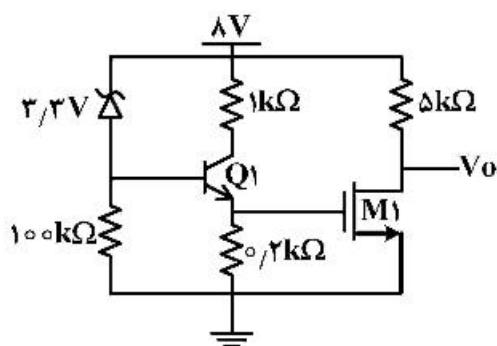
۱+۶ - مقدار ولتاژ خروجی چند ولت است؟
