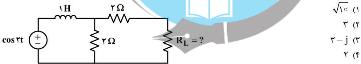
۱۷- در مدار زیر فازور ولتاژ  $V_s$  چقدر باشد تا توان متوسط در  $R_L$  برابر صفر شود؟ (دو منبع مستقل سینوسی، هم‌فرکانس هستند.)
