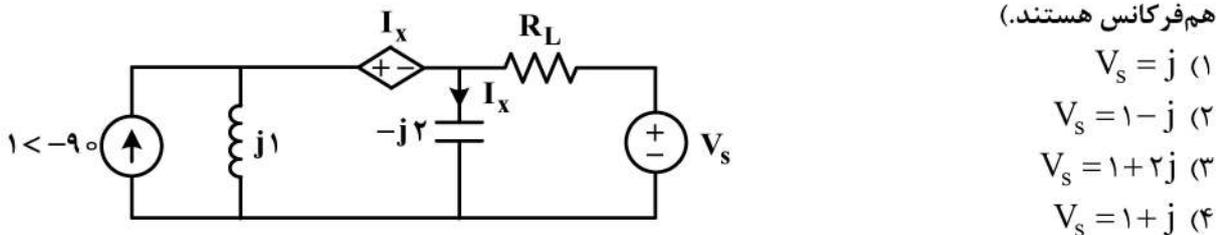
۱۸- مدار زیر در حالت دائمی است. اگر  $v_s(t) = b$  و  $i_s(t) = a \cos \omega t$  باشد ( $\omega$  نامعلوم است)، آنگاه توان متوسط در مقاومت  $R$  برابر  $P = 1W$  است، و اگر  $v_s(t) = 2b$  و  $i_s(t) = a \cos \omega t$  باشد، آنگاه توان این مقاومت به  $P = 4W$  می‌رسد. در مورد  $\omega$  چه می‌توان گفت؟ ( $\omega \neq 0, \infty$ )
