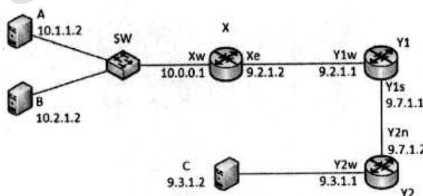
گره‌های A و B و C میزبان هستند و SW یک سوئیچ است. گره‌های X و Y1 و Y2 مسیریاب هستند. آدرس IP و MAC هر رابط (interface) در کنار آن نشان داده شده است (مثلاً آدرس IP رابط میزبان A برابر ۱۰.۱.۱.۲ و آدرس MAC آن برابر A است). کدام گزینه می‌تواند network mask درستی برای میزبان‌های A و B باشد؟
