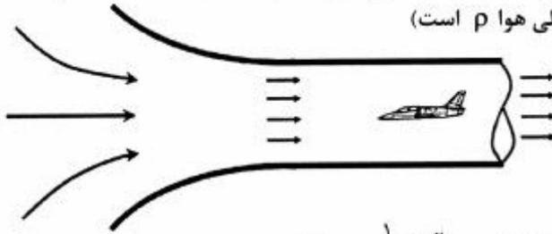
(۱) فشار سکون روی مدل  $P_{atm}$ ، فشار استاتیک اتاقک آزمون  $P_{atm} - \frac{1}{2}\rho V_m^2$
