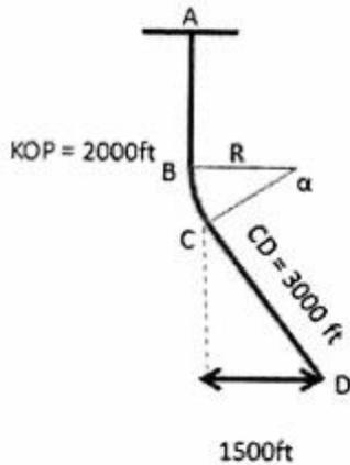
۲۵- شکل مقابل یک چاه جهت دار را نشان می دهد. اگر طول کل چاه برابر ۶۰۰۰ft باشد با توجه به اطلاعات داده شده روی شکل DLS (تغییر زاویه به ازای طول) برای بخش Build (منحنی) چقدر است؟
